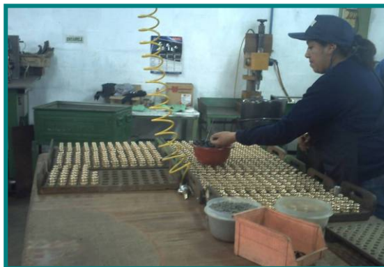
Fotografía No. 5.2-12 Área de incorporación de piezas internas de las válvulas (cauchos, pistones, resortes y tubeto plástico)
