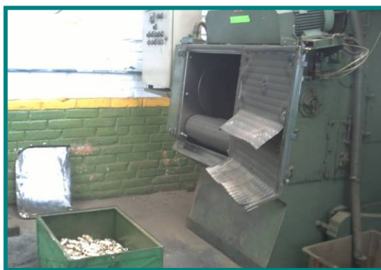
Fotografía No. 5.2-12: Pulido de las válvulas con granalla de acero, se produce un polvo fino de granalla que se recolecta en un recipiente metálico.
