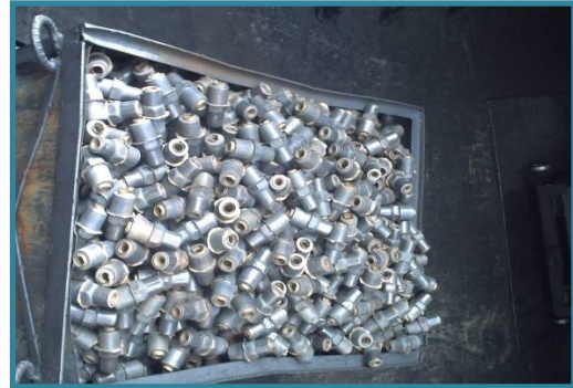
Fotografía No. 5.2-8: producto forjado conformación de válvulas
